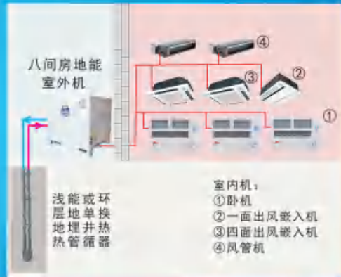
八间房暖冷一体化地能热宝系统
